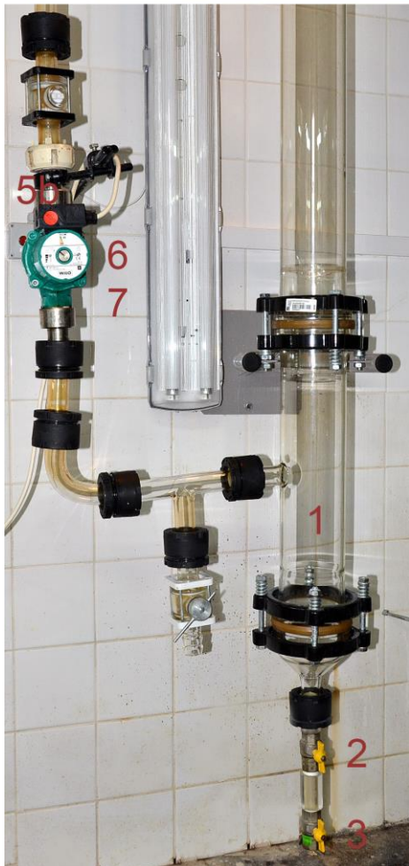
Obr. 7-2 Schéma zařízení pro měření usazovací rychlosti částic
